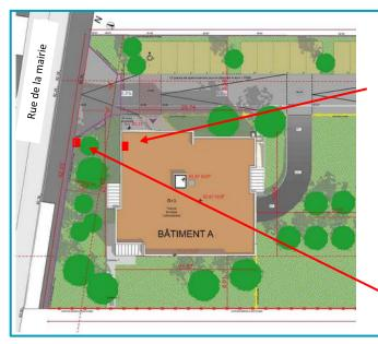
Indiquez nous l'emplacement souhaité du panneau de comptage (en général, il est placé à proximité directe du tableau électrique posé par votre électricien à l'intérieur de la construction).
